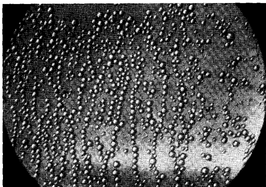
Рис. 4. Микрофотография агрегатов, образующихся в латексе под действием внешнего электрического поля
